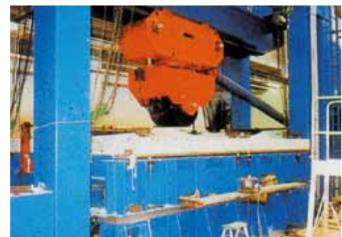
旧建設省土木研究所(財)土木研究センター、長岡15社による共同研究「道路橋床版の輪荷重走行試験機における疲労耐久性評価手法の開発」(平成11年10月)より
